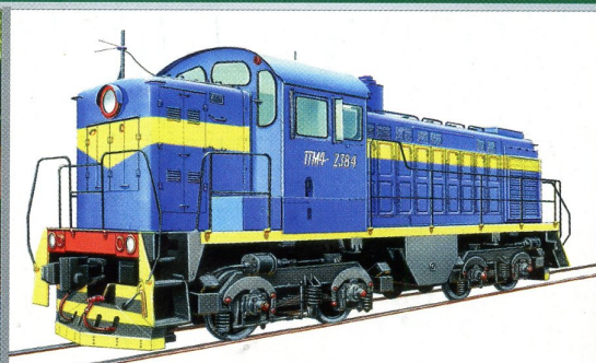
ТЕПЛОВОЗ СЕРИИ TGM4 ТИПА 0-2-2-0
